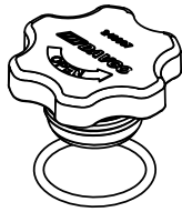
A. Vent Cap Assembly
